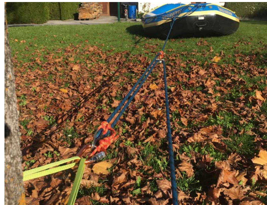
Abb. 9.9: Überblick Flaschenzug mit Statikseil, dass sowohl als Hauptseil als auch für die Ausgleichsverankerung verwendet wird.
