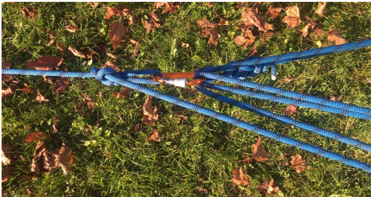
Abb. 9.7: 3-Punkt Ausgleichsverankerung mit dem Statikseil des Flaschenzuges (close up)
