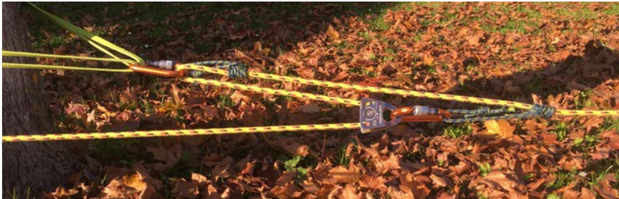
Abb. 9.2: Einfacher Flaschenzug mit Wurfsack und einer Seilrolle
