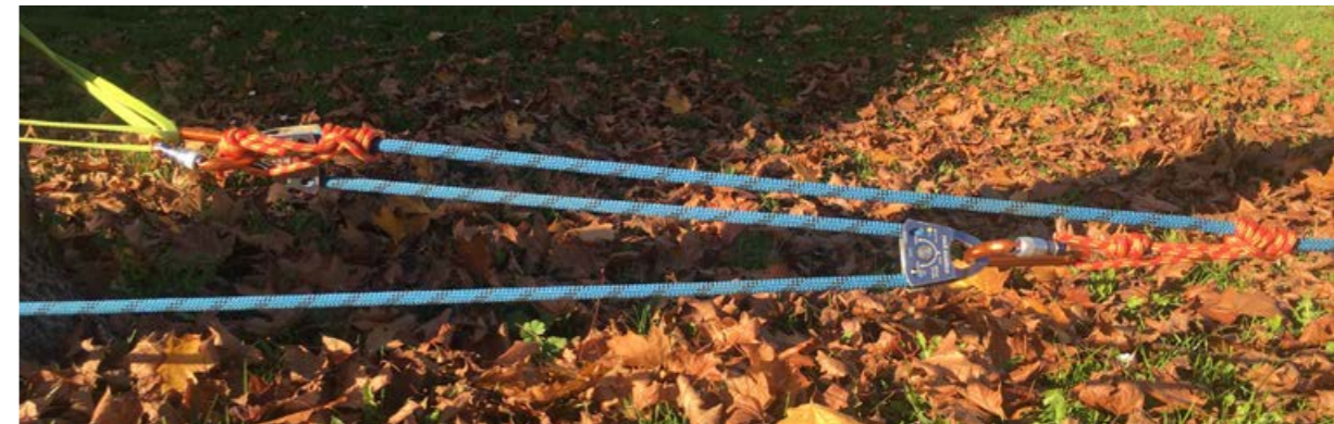
Abb. 9.4: Einfacher Flaschenzug mit 11 mm Statikseil und 2 Seilrollen
