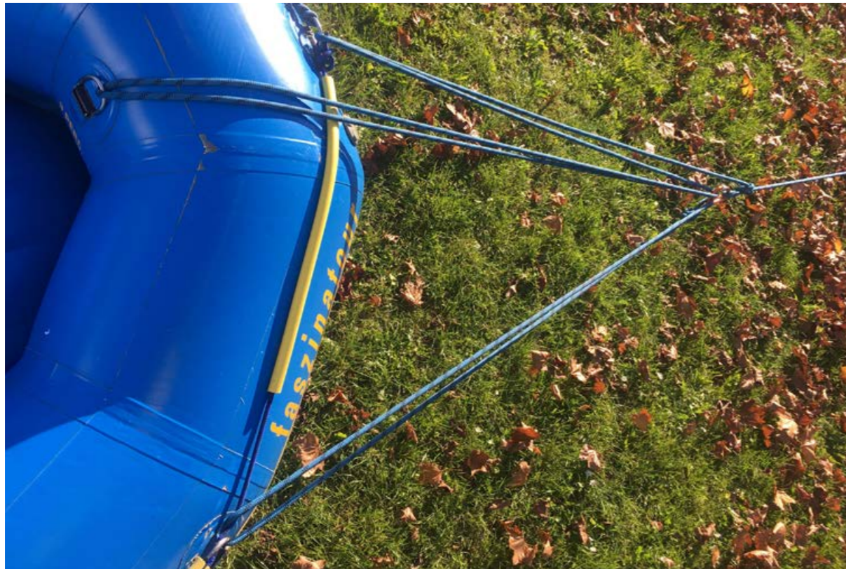
Abb. 9.6: 3-Punkt Ausgleichsverankerung mit dem Statikseil des Flaschenzuges
