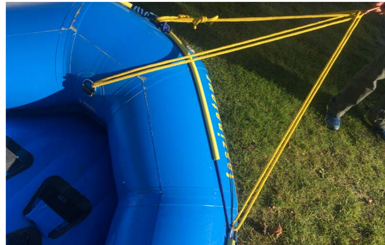
Abb. 9.5: 3-Punkt Ausgleichsverankerung mit der Frontleine des Rafts
