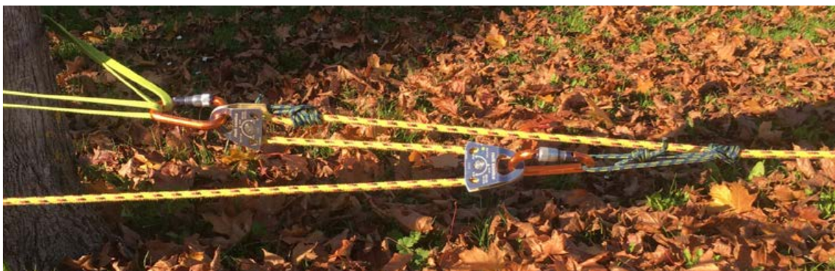
Abb. 9.3: Einfacher Flaschenzug mit Wurfsack und zwei Seilrollen
